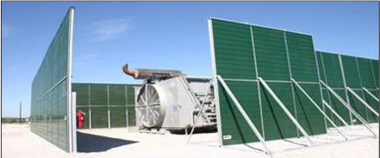
Εικόνα 6: Παράδειγμα χρήσης ηχοπετασμάτων σε σταθερές πηγές θορύβου
